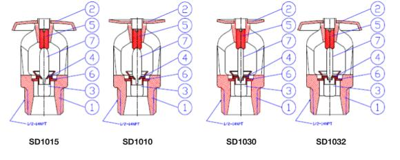
1. Frame 2. Deflector 3. Cap 4. Cap Seat 5. Load Screw 6. Seal 7. Bulb
