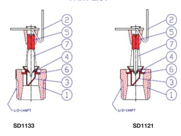
1. Frame 2. Deflector 3. Cap 4. Cap Seat 5. Load Screw 6. Seal 7. Bulb
